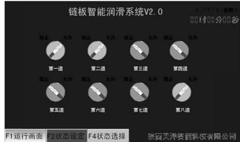
在任意画面点击F3使能按钮，屏幕转到状态使能画面。可完成对每条链板功能控制。每一条链板对应一个控制按钮，按钮有禁止和允许两个选项。在禁止状态下，关闭本道链板所有功能。操作时直接点击屏幕选择的按钮，此项操作有密码保护。（密码999）
